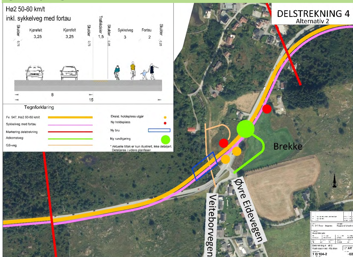
Figur 5-38: Tiltakskart delstrekning 4 alternativ 2.1: gang- og sykkelløsning på sørsiden
