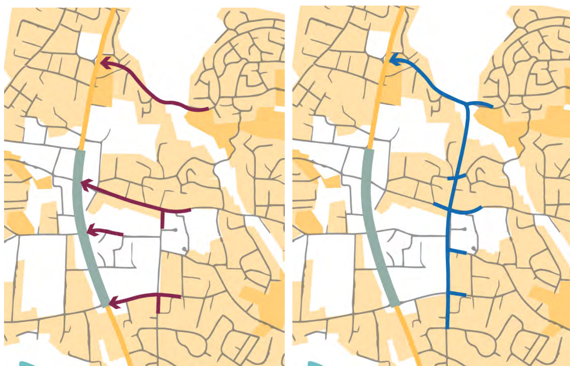
Figur 5-4: I dag ledes store deler av boligtrafikken rett ut på fv. 547 i det viktigste sentrumsstrekket. Med ny rundkjøring ved Rådhusvegen og kobling mellom Tostemvegen og Åkravegen (til høyre) vil trafikken i større grad ledes ut ved amfikrysset. Dette vil potensielt redusere trafikken i sentrum og føre til en forbedring av vegsystemet i Åkra.
