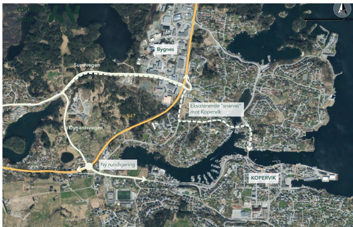
Figur 5-57: Mange bilister bruker i dag "snarveien" gjennom boligvegene for å komme seg til Kopervik. Denne utfordringen fjernes ved etableringen av en 4-armet rundkjøring.
