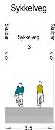
Figur 5-63: forslag til profil for sykkelveg parallelt med fylkesvegen.
