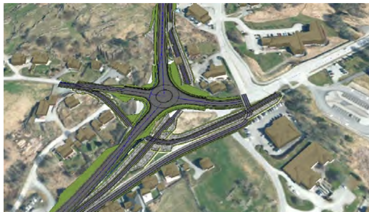
Figur 5-58: Ny firearmet rundkjøring i alternativ 2 med et felt i tilfartene og utkjøringene..
