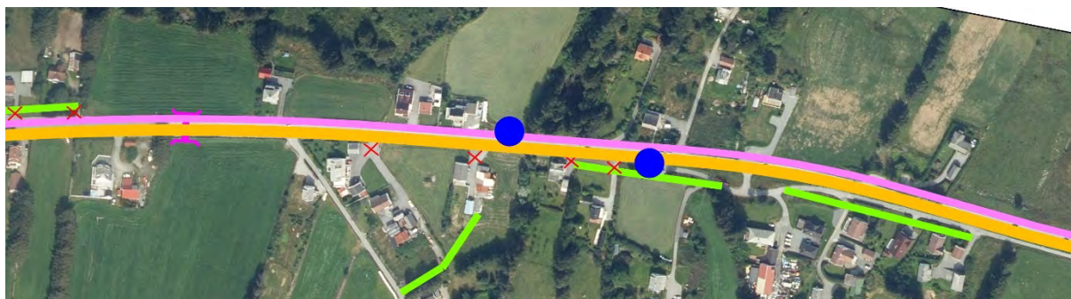
Figur 5-29: I alternativet legges gang- og sykkeløsningen på nordsiden av fylkesvegen langs hele delstrekningen.
