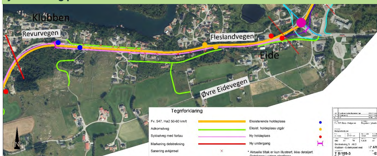
Figur 5-46: Tiltakskart delstrekning 5 alternativ 3: gang- og sykkelløsning på nordsiden.
