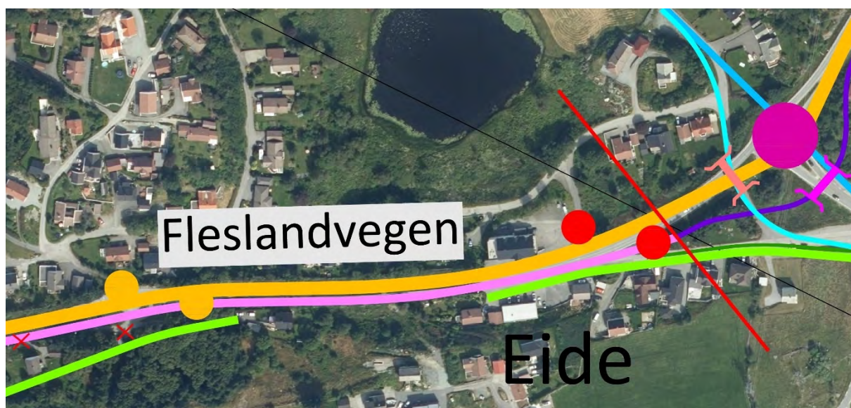
Figur 5-50: Eksisterende bussholdeplasser (markert i gult) flyttes nærmere Eidekrysset (markert i rødt). Gående mellom de to undergangene kan benytte gang- og sykkelundergangen under Eidekrysset.
