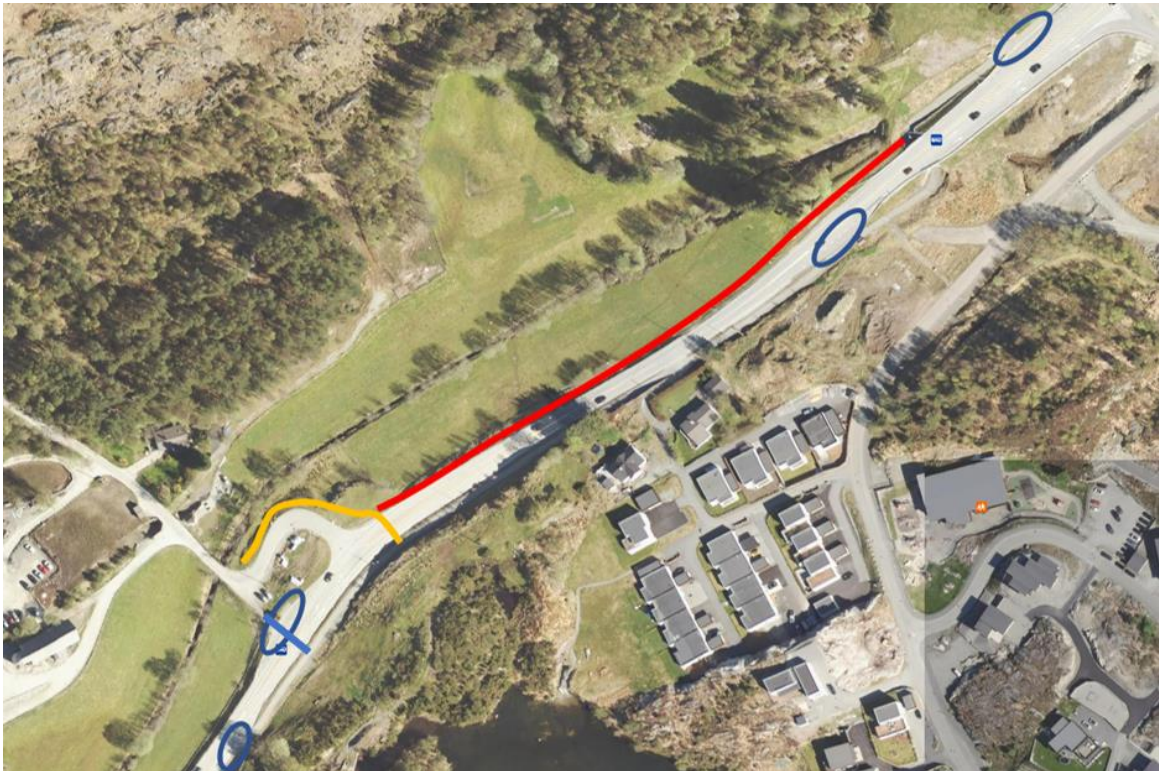
Figur 1: Vurderte alternativer. Rød trasé er forkastet og gul trasé viser løsningen som ønskes bygd
