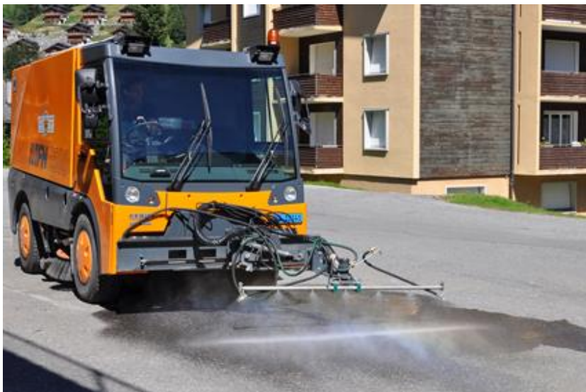
Figur 13: Øverst til venstre vises salt som brukes til støvdemping av ikke asfalterte internveier. Øverst til høyre vises spredning med dustex (kilde: dustex.no). Nederst vises en feiebil som brukes på asfalterte veier (kilde: tiltak.no).
