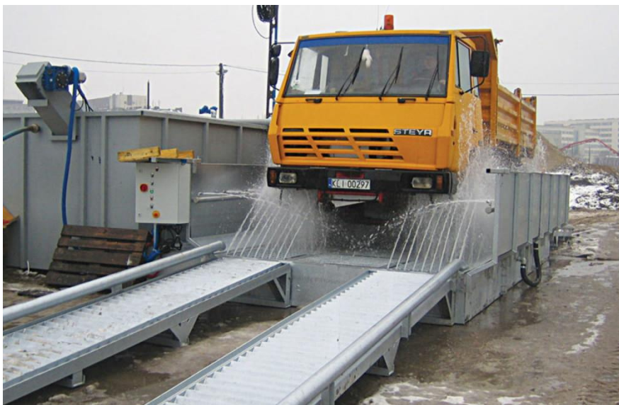
Figur 11: Bilde av underspylingsanlegg (kilde: tungt.no)
