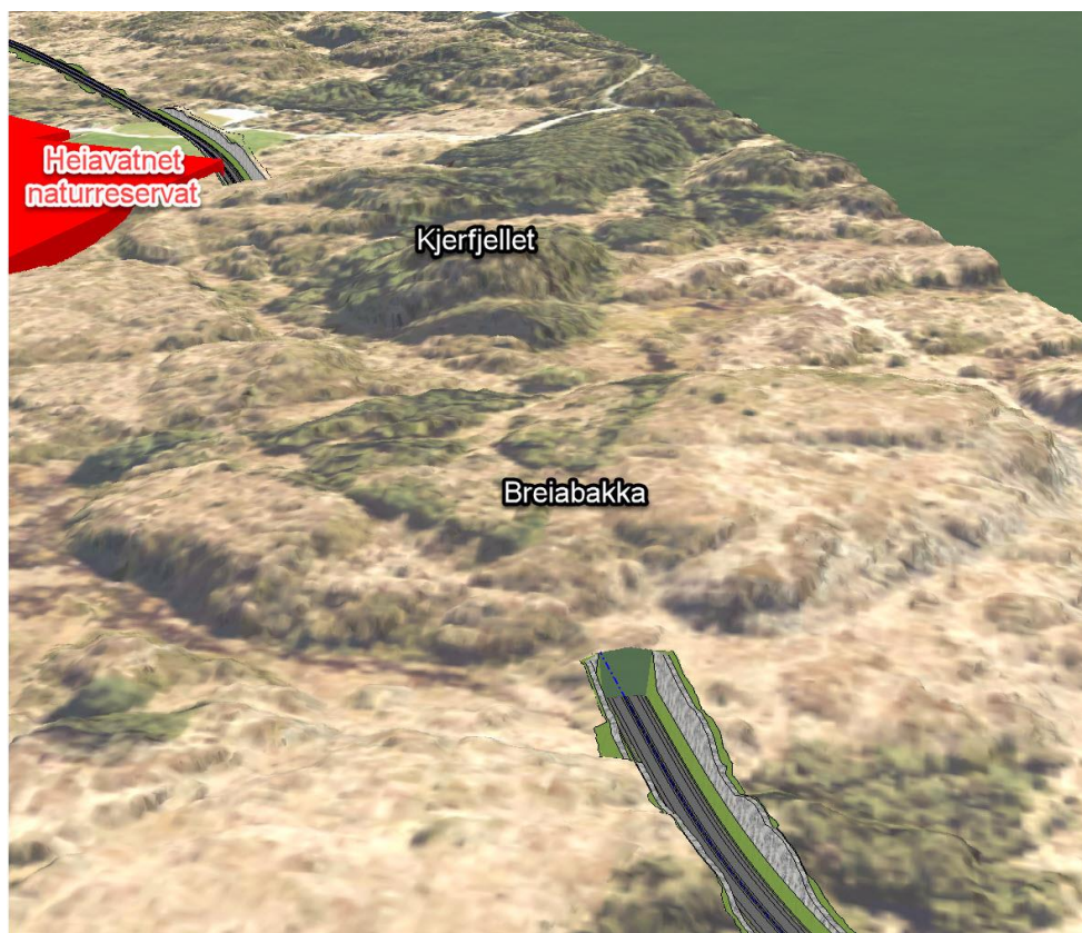
Figur 3.13: alternativ 2B, tunnel under Breiabakka og Kjærfjellet
