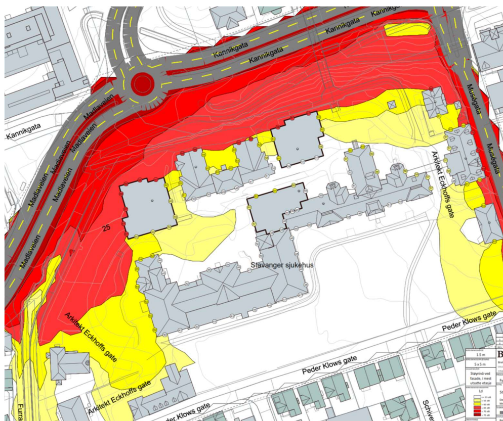
Figur 56 Beregnet støynivå etter utbygging.
