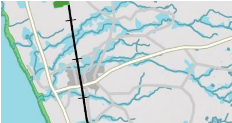
Figur 2 Kartet viser framstilling av de blå verdiene i området rundt Varhaug. Mørk blå farge viser elve – og bekkestrenger. Lys blå farge viser NVE sitt aktsomhetskart for flom.
